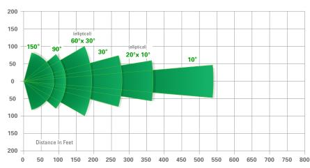
Angle: **150°** Range: 80ft /24m HFOV: 155ft /47m Angle: **90°** Range: 120ft /36m HFOV: 152ft /46m Angle: **60°x 30°** Range: 190ft /58m HFOV: 190ft /58m Angle: 30° Range: 270ft /82m HFOV: 140ft /42m Angle: **20°x 10°** Range: 360ft /109m HFOV: 112ft /34m Angle: **10°** Range: 540ft /164m HFOV: 94ft /28m
